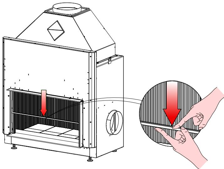
Abb. 1: Gnistbeskyttelsesgitter
